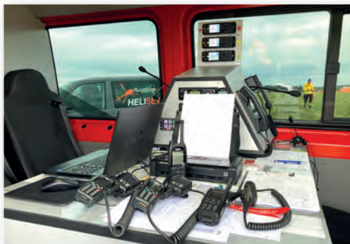
Digitalfunk im Feuerwehrfahrzeug
